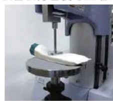
软管软膏包装等压缩试验
