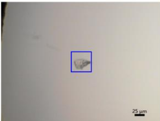
显微红外透射模式异物的成像 (15X)
