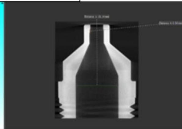
金属零件的内部尺寸测量
