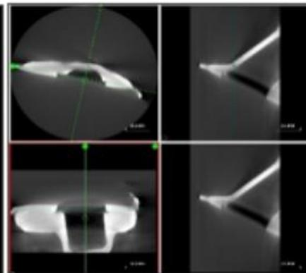
焊锡处裂纹的断面分析
